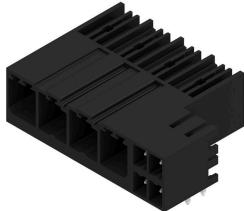
Connecteur mâle combiné à 90° avec contacts de signaux et de puissance avec raccordement PUSH IN incluant une bride centrale à verrouillage et (en option), un raccordement de blindage enfichable, au pas de 7,62. Permet le raccordement simultané de la puissance, des signaux et (en option) d'un blindage CEM. Idéal pour le raccordement d'entraînements par servomoteur et asynchrones.
