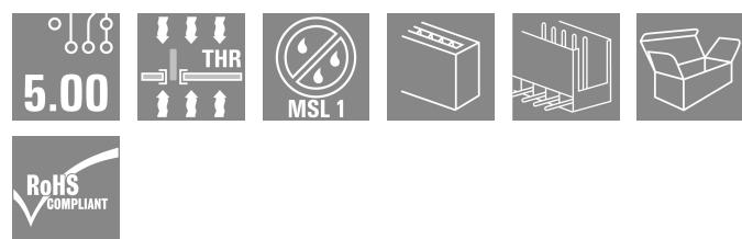
Connecteurs mâles avec longueur de picot optimisée pour soudure à la vague. Ils peuvent être repérés et codés.
