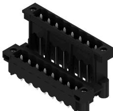
Connecteurs mâles résistants aux hautes températures, à double étage, disposés latéralement, avec bride ou bride à souder. Picot à souder de 1,5 mm valable pour les applications de soudure par refusion. Picots de 3,2 mm adaptés à la soudure à la vague et par refusion. Ils peuvent être repérés et codés.
