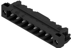
Connecteur mâle résistant aux températures élevées, avec conditionnement en boîte ou en rouleau. En rouleau, avec picot à souder 1,5 mm, optimisé pour l'implantation automatique. Longueurs de picots de 3,2 mm indiquées pour les applications de soudure à la vague et par refusion. Les connecteurs mâles disposent d'espace pour les marquages et peuvent être codés. HC = Courant fort.
