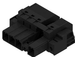
Connecteur mâle inversé à 180° avec raccordement PUSH IN pour câblage de terrain 6 mm<sup>2</sup> au pas de 7,62, réalisant une « version à trois brides » pour passage boîtier. Convient aux boîtiers dont l'épaisseur de paroi ne dépasse pas 16 mm.
