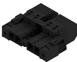
Connecteur mâle inversé à 180° avec raccordement PUSH IN pour câblage de terrain 6 mm<sup>2</sup> au pas de 7,62, réalisant une « version à trois brides » pour passage boîtier. Convient aux boîtiers dont l'épaisseur de paroi ne dépasse pas 2 mm.
