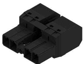
Connecteur mâle inversé à 180° sans tension inverse, avec raccordement PUSH IN pour câblage de terrain. Avec bride centrale à verrouillage automatique pour câblage de terrain 6 mm<sup>2</sup> au pas de 7,62. En plus, convient idéalement comme solution de protection des doigts pour tensions inverses. Satisfait les exigences des normes UL1059 600 V classe C et CEI 61800-5-1. Sur demande, également disponible sans la bride centrale.
