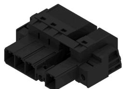
Connecteur mâle inversé à 180° avec raccordement PUSH IN pour câblage de terrain 6 mm<sup>2</sup> au pas de 7,62, réalisant une « version à trois brides » pour passage boîtier. Convient aux boîtiers dont l'épaisseur de paroi ne dépasse pas 16 mm.
