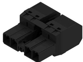
Connecteur mâle inversé à 180° sans tension inverse, avec raccordement PUSH IN pour câblage de terrain. Avec bride centrale à verrouillage automatique pour câblage de terrain 6 mm<sup>2</sup> au pas de 7,62. En plus, convient idéalement comme solution de protection des doigts pour tensions inverses. Satisfait les exigences des normes UL1059 600 V classe C et CEI 61800-5-1. Sur demande, également disponible sans la bride centrale.
