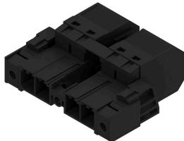
Connecteur mâle inversé à 180° avec raccordement PUSH IN pour câblage de terrain 6 mm<sup>2</sup> au pas de 7,62, réalisant une « version à trois brides » pour passage boîtier. Convient aux boîtiers dont l'épaisseur de paroi ne dépasse pas 2 mm.
