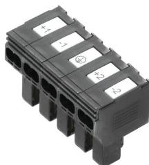
Distribution de puissance avec câble non sectionné d'une section de 1,5 à 6 mm<sup>2</sup>. Alimentation / branche T via raccordement PUSH IN (0,5 à 10 mm<sup>2</sup>) et/ou raccordement débrochable (0,5 à 4 mm<sup>2</sup>). Les repérages de couleur permettent un brochage clair des fils.
