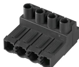
Connecteur mâle inversé à 180° avec raccordement à étrier pour câblage de terrain 2,5 mm<sup>2</sup> au pas de 7,62. En plus, convient idéalement comme solution de protection des doigts pour tensions inverses.
