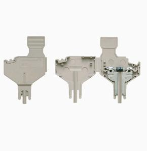
La fiche avec composant est utilisée pour intégrer des composants électriques dans un bloc de jonction sectionnable. Après avoir soudé les composants électriques, le mâle peut être intégré dans la zone de déconnexion de nos blocs de jonction sectionnable et change ainsi le bloc de jonction sectionnable en bloc de jonction modulaire avec composants électriques intégrés.
