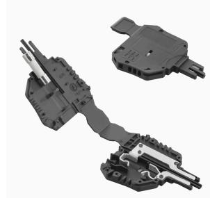
Le support fusible SIHA permet de transformer en un tour de main un bloc de jonction sectionnable en bloc de jonction à fusible : il suffit simplement de remplacer le levier de sectionnement par une fiche fusible.
