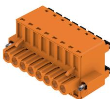
La solution performante "Daisy-Chain" permettant de réaliser un bus avec des signaux de puissance peut être utilisée pour des alimentations auxiliaires jusqu'à 18,5 A sous 400V. La capacité de raccorder des sections jusqu'à 2,5mm<sup>2</sup> est particulièrement intéressante pour réaliser des bus sur de longues distances grâce à la faible chute de tension dans les contacts.
