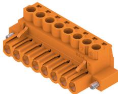
Connecteur femelle avec raccordement à vis à étrier pour le raccordement de conducteurs à orientation de sortie droite (180°). Les connecteurs femelle disposent d'espace pour les marquages et peuvent être codés. Fixation par bride ou par levier de verrouillage. Ils disposent également d'une vis plus/moins intégrée et d'une protection contre toute mauvaise insertion du connecteur. Ils sont livrés avec étriers ouverts. HC = Courant fort.
