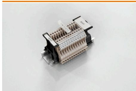
Les supports de repérage de groupe SchT 5 S sont encliquetés directement sur les rails profilés TS 32 (G-rail) ou TS 35 (top-hat rail). Le repérage du bornier peut ainsi être réalisé indépendamment des bornes et du type de borne.
