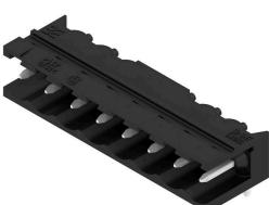
Connecteur mâle ouvert, coudé 90°, résistant aux hautes températures. Conditionnement en boîte ou en rouleau. En rouleau, avec picot à souder 1,5 mm, optimisé pour l'implantation automatique. Longueurs de picots de 3,2 mm indiquées pour les applications de soudure à la vague et par refusion. Les connecteurs mâles disposent d'espace pour les marquages et peuvent être codés. HC = Courant fort.
