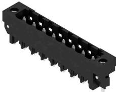
Connecteur mâle résistant aux températures élevées, avec conditionnement en boîte ou en rouleau. En rouleau, avec picot à souder 1,5 mm, optimisé pour l'implantation automatique. Longueurs de picots de 3,2 mm indiquées pour les applications de soudure à la vague et par refusion. Les connecteurs mâles disposent d'espace pour les marquages et peuvent être codés. HC = Courant fort.
