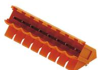
Connecteurs mâles avec sortie à 135°. La longueur des picots est optimisée pour la soudure à la vague. Ils peuvent être repérés et codés.
