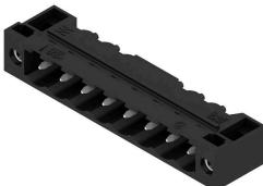
Connecteur mâle résistant aux températures élevées, avec conditionnement en boîte ou en rouleau. En rouleau, avec picot à souder 1,5 mm, optimisé pour l'implantation automatique. Longueurs de picots de 3,2 mm indiquées pour les applications de soudure à la vague et par refusion. Les connecteurs mâles disposent d'espace pour les marquages et peuvent être codés. HC = Courant fort.
