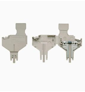
La fiche avec composant est utilisée pour intégrer des composants électriques dans un bloc de jonction sectionnable. Après avoir soudé les composants électriques, le mâle peut être intégré dans la zone de déconnexion de nos blocs de jonction sectionnable et change ainsi le bloc de jonction sectionnable en bloc de jonction modulaire avec composants électriques intégrés.
