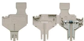
La fiche avec composant est utilisée pour intégrer des composants électriques dans un bloc de jonction sectionnable. Après avoir soudé les composants électriques, le mâle peut être intégré dans la zone de déconnexion de nos blocs de jonction sectionnable et change ainsi le bloc de jonction sectionnable en bloc de jonction modulaire avec composants électriques intégrés.
