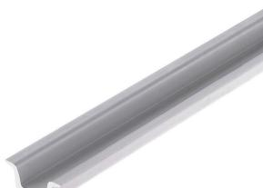
Les rails plastiques DIN ont des propriétés isolantes et sont très légers. Ils peuvent être utilisés lorsque les distances de dégagement et de fluage à la plaque de maintien ne peuvent être atteintes avec des rails DIN standard.
