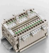
Le support de repérage offre la possibilité de montage supplémentaire de repérages standard avec un pas de 5 ou 5,1 mm. Les supports coudés peuvent éventuellement être assemblés par encliquetage et pourraient être montés dans tous les canaux de repérage de standard des blocs de jonction modulaires Klippon®. Les types de repérage de montage se trouvent sous les accessoires respectifs du support de repère de désignation.
