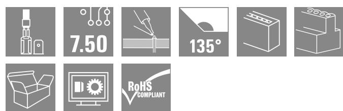
Conexión por terminales planos con dirección de conductor de 90°, 135° y 180° para conectores planos de 6,3 y 2,8 mm con paso de 7,50 mm.
