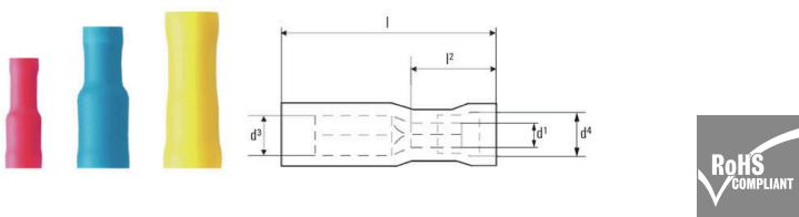
Manguitos aislados de conexión redondos en PVC con manguito de cobre
