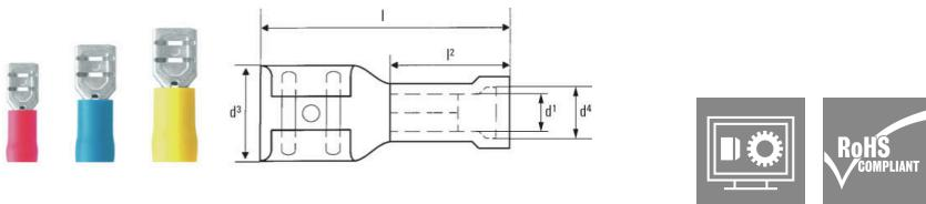
Manguitos aislados de conexión plana en PVC con maniquito de cobre
