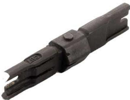
**Herramienta de inserción para par trenzado****Diferentes cuchillas para regletas de conexión**
