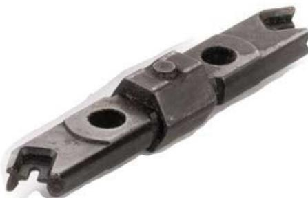
**Herramienta de inserción para par trenzado****Diferentes cuchillas para regletas de conexión**
