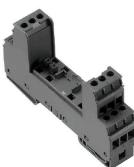
Base para los descargadores enchufables VSPC, pie PE integrado en la base sin efecto en cuanto a la impedancia VSPC BASE; deriva a tierra hasta 20 kA (8/20 µs) y 2,5 kA (10/350 µs) de forma segura.
