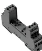
Base para los descargadores enchufables VSPC. Pie PE integrado en la base del VSPC BASE con impedancia neutral y conexión PE libre de masa (FG) mediante descargador de arco, que deriva de forma segura hasta 20 kA (8/20 µs) y 2,5 kA (10/350 µs) de forma segura a tierra. Indicado para circuitos de señales no conectados a tierra.
