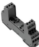
Base para los descargadores enchufables VSPC. Pie PE integrado en la base del VSPC BASE con impedancia neutral y conexión PE libre de masa (FG) mediante descargador de arco, que deriva de forma segura hasta 20 kA (8/20 µs) y 2,5 kA (10/350 µs) de forma segura a tierra. Indicado para circuitos de señales no conectados a tierra.
