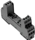
Base para los descargadores enchufables VSPC, pie PE integrado en la base sin efecto en cuanto a la impedancia VSPC BASE; deriva a tierra hasta 20 kA (8/20  $\mu$ s) y 2,5 kA (10/350  $\mu$ s) de forma segura.
