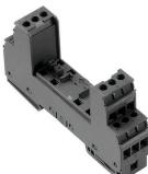
Base para los descargadores enchufables VSPC. Pie PE integrado en la base del VSPC BASE con impedancia neutral y conexión PE libre de masa (FG) mediante descargador de arco, que deriva de forma segura hasta 20 kA (8/20  $\mu$ s) y 2,5 kA (10/350  $\mu$ s) de forma segura a tierra. Indicado para circuitos de señales no conectados a tierra.
