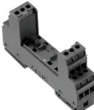
Base para los descargadores enchufables VSPC, pie PE integrado en la base sin efecto en cuanto a la impedancia VSPC BASE; deriva a tierra hasta 20 kA (8/20 µs) y 2,5 kA (10/350 µs) de forma segura.
