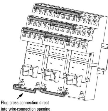
Insertar las conexiones transversales
