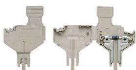
El enchufe para elementos de construcción se utiliza para integrar un componente eléctrico en un bloque de bornes seccionables. Después de soldar el componente electrónico, el conector macho se puede integrar en el área de desconexión de nuestros bloques de bornes seccionables y así cambia la regleta de bornes seccionables en una regleta de bornes modular con componente electrónico integrado.
