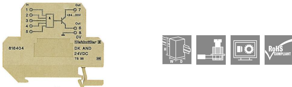
Funciones lógicas AND, NAND, OR y NOR en bornes con sección nominal de 4 mm<sup>2</sup>. Constan respectivamente de 5 entradas, conectadas lógicamente, que se transmiten por una salida PNP 24 V / 20 mA. Los componentes lógicos ofrecen un amplio espectro de aplicaciones para el acoplamiento de señales digitales de sensores y actuadores con equipos de automatización.
