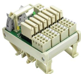
Elementos de interfaz RS F40 o RS F10 para 32 u 8 señales que permiten aislar mediante relé las señales que provienen del PLC con los sensores y actuadores de campo.
