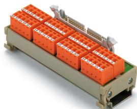
Elementos de interfaz pasivos RS F40 o RS F10 para 32 u 8 señales que permiten conectar con eficiencia sensores y actuadores periféricos a los módulos de entrada/salida del PLC mediante los cables prefabricados.
