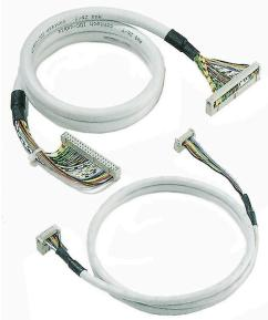
El cable de control prefabricado dispone de conectores hembra enchufable de 10 o 40 polos según IEC 603/1 DIN 41 651. Se utiliza, entre otros usos, para conectar el adaptador frontal del PLC a los interfaces activos o pasivos de Weimüller. Están disponibles en diferentes longitudes.
