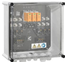
Las PV DC combiner boxes para inversores con segidores de 1 a 12 MPP se utilizan para proteger el lado de CC de un sistema fotovoltaico. Las combiner boxes protegen el inversor contra las sobretensiones y cumplen así la directiva europea CLC/TS 51643-32. Además, estos productos ofrecen la posibilidad de proteger el sistema contra las corrientes inversas y la posibilidad de combinar cadenas para ahorrar cables durante la instalación.
