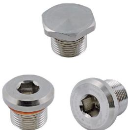
Los tapones de la serie VP permiten rellenar las entradas no utilizadas en equipos con clasificación Ex y mantener la protección antideflagrante Ex d y la protección de explosión de seguridad mejorada Ex e, así como los niveles de protección IP66/67/68.
