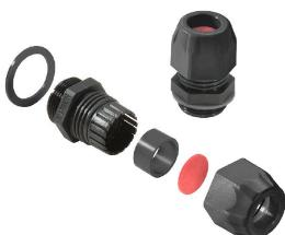
Presaestopas de poliamida aptos para su uso en zonas con peligro de explosión Ex e (seguridad aumentada) y Ex i (seguridad intrínseca). Weidmüller ofrece una familia de productos sin restricciones y, además del cumplimiento de las normas, el presaestopas destaca por su mayor resistencia al impacto de 4/7 julios y un rango de temperaturas admisible de hasta -60°C sin restricciones. Han sido probados conforme a la norma vigente y a la directiva EN 60079-0, disponen de certificación ATEX e IECEx.
