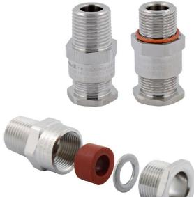
Los prensaestopas A2L son ideales para cables sin blindaje, ya que mantienen el nivel de protección antideflagrante Ex d y la protección de explosión de seguridad mejorada Ex e.
