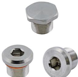
Los tapones de la serie VP permiten llenar las entradas no utilizadas en equipos con clasificación Ex y mantener la protección antideflagrante Ex d y la protección de explosión de seguridad mejorada Ex e, así como los niveles de protección IP66/67/68.
