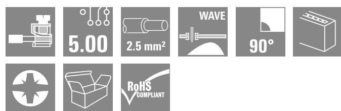
Borne para placas de circuitos impresos con conexión hembra por pisador con paso de 5,00 y 5,08 mm. Dirección de salida del conductor de 90°. Idóneo para secciones de conductor de hasta 2,5 mm<sup>2</sup>.
