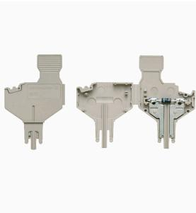
El enchufe para elementos de construcción se utiliza para integrar un componente eléctrico en un bloque de bornes seccionables. Después de soldar el componente electrónico, el conector macho se puede integrar en el área de desconexión de nuestros bloques de bornes seccionables y así cambia la regleta de bornes seccionables en una regleta de bornes modular con componente electrónico integrado.
