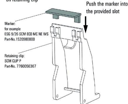
Cómo instalar el señalizador en clip de retención
