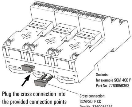
Cómo instalar la conexión transversal contactos A2 de conexión transversal de SCM... Conectores hembra PUSH IN
