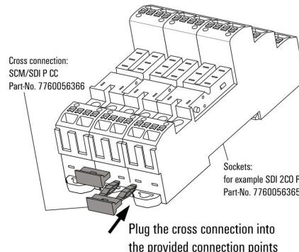
Cómo instalar la conexión transversal contactos A2 de conexión transversal de SDI Conectores hembra PUSH IN
