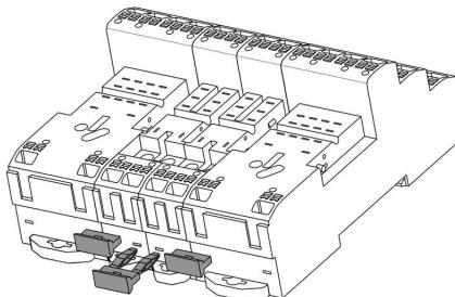
Cómo instalar la conexión transversal contactos A2 de conexión transversal de SCM... Conectores hembra PUSH IN
