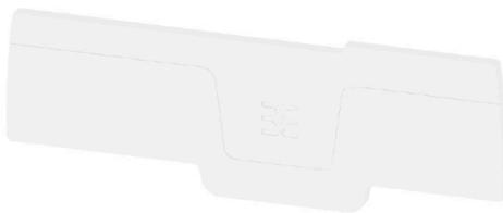
Las tapas de cierre se sujetan en la parte abierta del último borne antes del ángulo de fijación lateral. El empleo de la tapa de cierre permite mantener la función del borne así como la tensión nominal indicada. Además, garantiza una protección de contacto para las partes que soportan tensión. El borne final es a prueba de contacto con los dedos.
