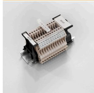
El portaetiquetas para conjuntos <B>SchT 5</B> se enclavará directamente en el carril TS 32 (guía perfil asimétrico) o en el carril TS 35 (guía perfil simétrico). De esta forma la regleta de bornes puede identificarse con una etiqueta independientemente de los bornes incluidos en la regleta.
