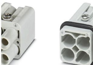
Serie HQ: grandes características en un diseño compacto. Las características eléctricas hablan por sí solas. La conexión de conductores se realiza mediante contactos crimpados. El método de conexión crimpada ha sido el estándar utilizado durante décadas. Los contactos crimpados no están incluidos con los conectores.
