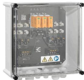
Las PV DC combiner boxes para inversores con seguidores de 1 a 12 MPP se utilizan para proteger el lado de CC de un sistema fotovoltaico. Las combiner boxes protegen el inversor contra las sobretensiones y cumplen así la directiva europea CLC/TS 51643-32. Además, estos productos ofrecen la posibilidad de proteger el sistema contra las corrientes inversas y la posibilidad de combinar cadenas para ahorrar cables durante la instalación.
