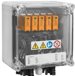
Las PV DC combiner boxes para inversores con seguidores de 1 a 12 MPP se utilizan para proteger el lado de CC de un sistema fotovoltaico. Las combiner boxes protegen el inversor contra las sobretensiones y cumplen así la directiva europea CLC/TS 51643-32. Además, estos productos ofrecen la posibilidad de proteger el sistema contra las corrientes inversas y la posibilidad de combinar cadenas para ahorrar cables durante la instalación.
