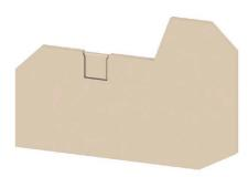
Las tapas de cierre se sujetan en la parte abierta del último borne antes del ángulo de fijación lateral. El empleo de la tapa de cierre permite mantener la función del borne así como la tensión nominal indicada. Además, garantiza una protección de contacto para las partes que soportan tensión. El borne final es a prueba de contacto con los dedos.
