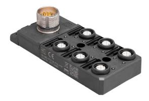
Mientras que en el sistema estándar M12 el manguito giratorio debe atornillarse y se ve obstaculizado por el bloqueo contra vibraciones, Push-Pull funciona con un solo clic, como el conocido sistema de conexión de mangueras en jardinería. El cierre con clic audible asegura una conexión segura así como una buena junta hermética. Los nuevos distribuidores SAI-Push-Pull pueden utilizarse tanto con los conectores M12 como con los nuevos conectores Push-Pull.
