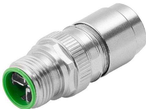
El conector de crimpado M12 Mini de 8 polos con codificación X y salida de cable a 90° está predestinado, por sus dimensiones compactas y sus 8 posiciones de salida de cable, para condiciones de instalación exigentes. La versión con abrazadera para cable, con un amplio rango de sujeción de 4 a 9 mm, junto con la carcasa totalmente apantallada y la descarga de tracción apantallada, es la solución universal a prueba de fallos para todos los cables estándar del mercado.
